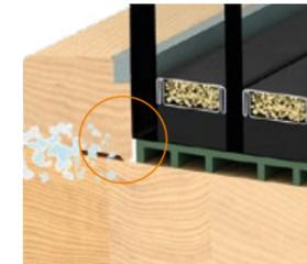
Damit bleiben Flügelholz- und Glasverbund stets trocken, intakt und auch optisch attraktiv: Die Abdichtung der Glashalteleiste mit der exklusiven Dampfstop®-Technologie von Gaulhofer für die Holz-/Alu-Fenster verhindert das Eindringen von feuchter Raumluft in den Glasfalz. Der Glasverbund bleibt trocken, das Flügelholz schön funktional.
