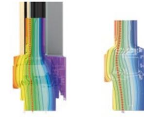
Keine Kondenswasserbildung im Falz und Lärm, Kälte, Wind und Regen präzise ausgesperrt: Die Audiostop®-Technologie von Gaulhofer weist drei umlaufende Dichtungen auf und sorgt durch die ideale Platzierung der Mitteldichtung für die optimale Berücksichtigung der 10-Grad-Isotherme – das stellt Wärme und Trockenheit in der Konstruktion sicher.
