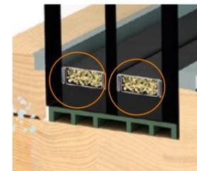
Der Wärmeschutz eines Fensters entscheidet, wie viel Wärmeenergie nach außen dringt. So bemisst der U-Wert den Wärmedurchgangskoeffizienten: Je kleiner, desto besser gedämmt. Alte Verbundfenster haben einen  $U_w$ -Wert von ca. 3,0. Zum Vergleich: Die ENERGYLINE PLUS von Gaulhofer kommt auf passivhaustaugliche 0,59! Die Gaulhofer-Thermostop®-Technologie sorgt durch hochwärmedämmende Glasabstandhalter zusätzlich, dass Kondensation entgegen gewirkt wird.
