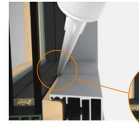
So kann keine Feuchtigkeit von außen oder innen in die Fensterkonstruktion eindringen: Die aufwändig von Hand eingepresste Nassversiegelung aus UV-beständigem Spezial-Silikon dichtet den Glasanschluss von Gaulhofer-Holz-Alu-Fenstern hermetisch sowie dauerhaft ab.
